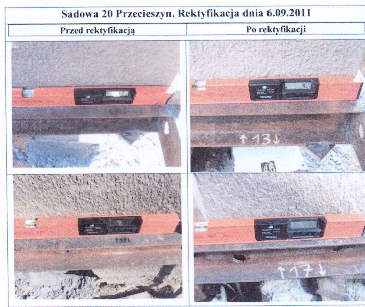
Rys. 2. Graficzna ilustracja przykładowych pomiarów geodezyjnych wykonanych w obrębie budynku wzniesionego w technologii tradycyjnej (pomiaru zestawione zostały w tablicy 4)
